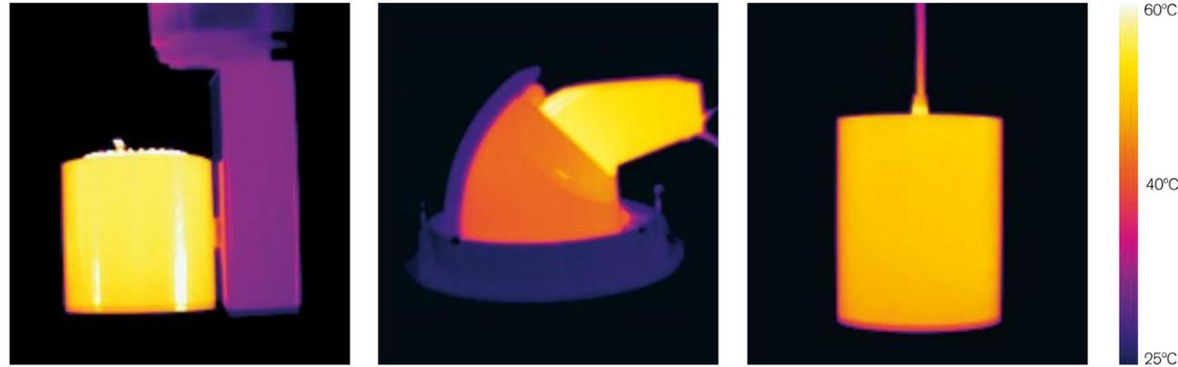
Gracias a que el cuerpo óptico es independiente del alojamiento de la fuente de alimentación, permite aislar térmicamente al driver de la luminaria, pues ésta es la parte más sensible a temperaturas elevadas.
